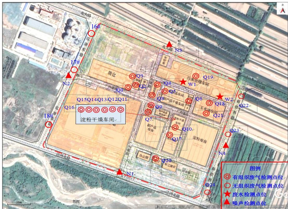
图 5-1 厂区平面布置及检测点位示意图
